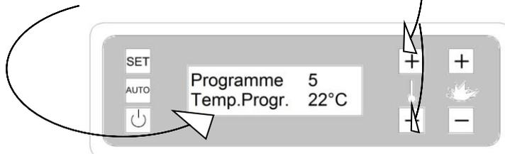
Pour allumer le poêle vous devez appuyer sur la touche **on/off** pendant quelques secondes. Le poêle passera automatiquement dans la phase d'allumage et chauffage. Dans le premier allumage et première charge de pellets, il sera nécessaire d'effectuer plusieurs cycles d'allumage de sorte que les granulés entrent dans le circuit de l'alimentation.
