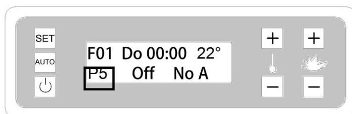
Nous conseillons de régler le poêle à la puissance moyenne élevée car l'électronique module la puissance quand le poêle a atteint la température de consigne.
