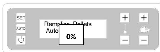
L'afficheur visualise « Auto » car le poêle est équipé du système de contrôle du dosage automatique des granulés, on visualise le pourcentage de correction mais l'utilisateur ne peut pas changer les valeurs.
