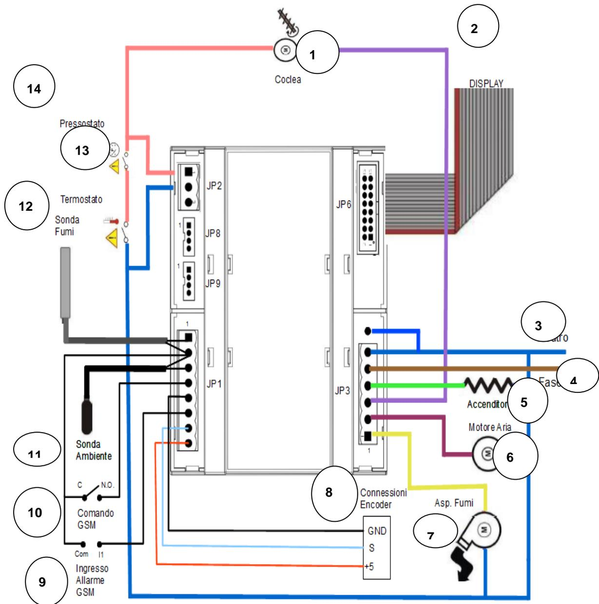
1 : vis sans fin ; 2 : afficheur ; 3 : neutre ; 4 : phase ; 5 : bougie ; 6 : ventilateur air ; 7 : extracteur des fumées ; 8 : connexions encodeur, 9 : accès alarme GSM ; 10 : commande GSM ; 11 : sonde ambiance ; 12 : sondes fumées ; 13 : thermostat ; 14 : pressostat.
