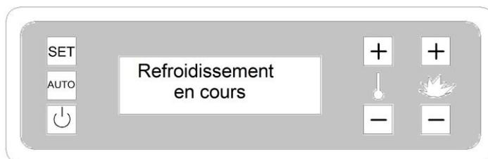
Le cycle d'arrêt peut durer 15-20 minutes, en fonction des paramètres et le type d'appareil. Lorsque le cycle est terminé, l'affichage revient aux mots : "poêle éteint" et le poêle s'arrête.
