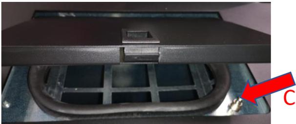
Si la fermeture est trop élevée, l'interrupteur C, ne reste pas pressé, par conséquent, l'alarme 6 se déclenche.
