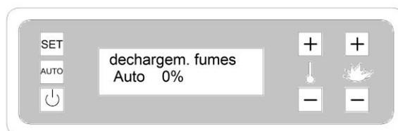
L'afficheur visualise « Auto » car le poêle est équipé du système pour la gestion automatique de la rotation du moteur extracteur de fumées et l'utilisateur ne peut pas modifier les valeurs.
