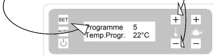
Pour allumer le poêle vous devez appuyer sur la touche **on/off** pendant quelques secondes. Le poêle passera automatiquement dans la phase d'allumage et chauffage. Dans le premier allumage et première charge de pellets, il sera nécessaire d'effectuer plusieurs cycles d'allumage de sorte que les granulés entrent dans le circuit de l'alimentation.
